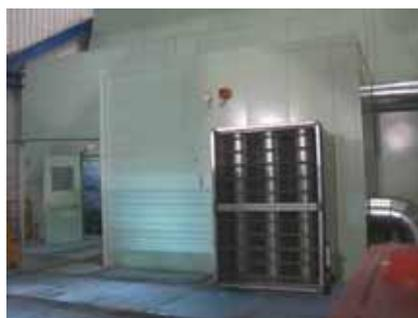
图 6 燃气轮机隔声罩照片
